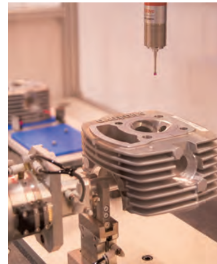
ロボットを用いた治具レス測定の様子
