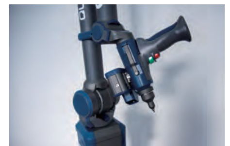
小型のレーザーラインプローブを取り付けた様子
