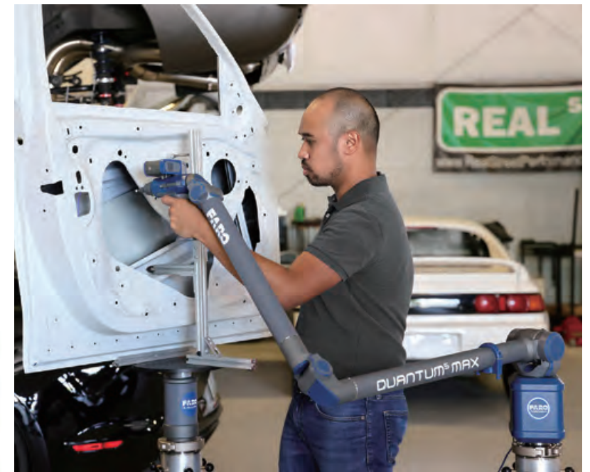
8-Axis(回転テーブル)を用いた測定の様子
