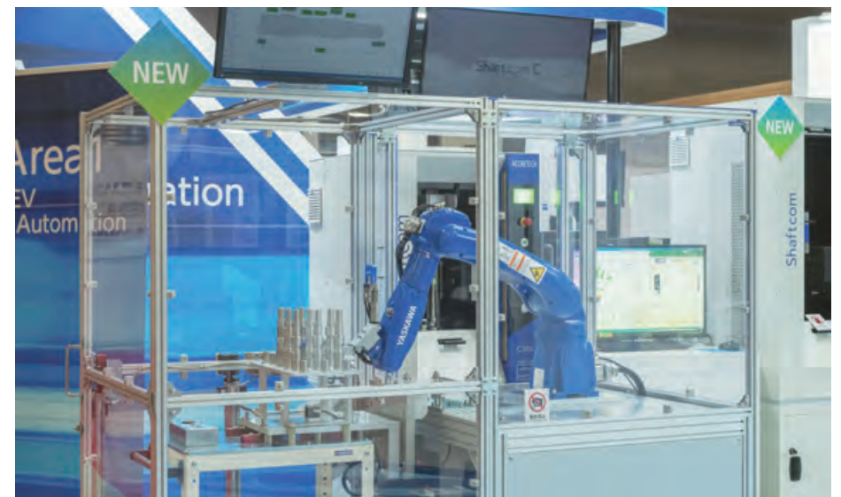
光学式シャフト形状測定機 Shaftcom (シャフコム)と協働ロボットによる測定の自動化ソリューション
